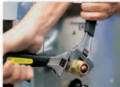
➤ Специальный дизайн для затяжки / контрирования в тесных местах
