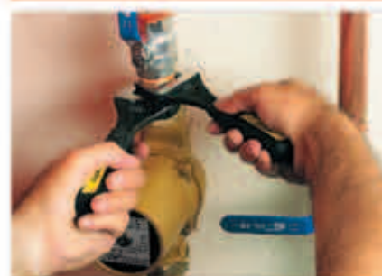
➤ Благодаря широкому раскрытию и тонкому профилю губок ключи IREGA SWO работают там, где обычные ключи не могут.
